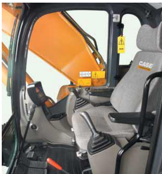
FIGURA 14 - Escavadeira Hidráulica - Compartimento do Operador.
