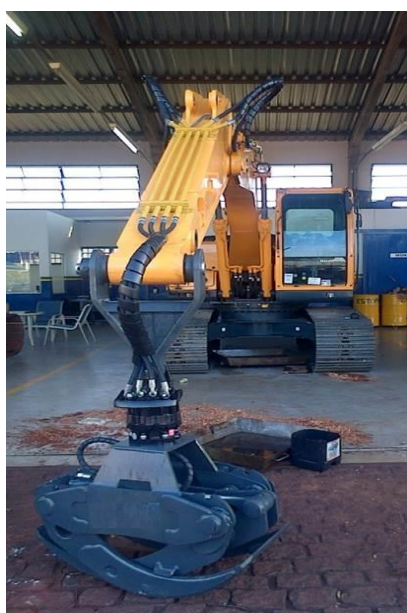
FIGURA 21 - Escavadeira Hidráulica com Conjunto Florestal.
