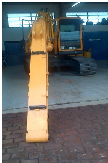
FIGURA 20 - Escavadeira Hidráulica com Suporte para Encanamento.
