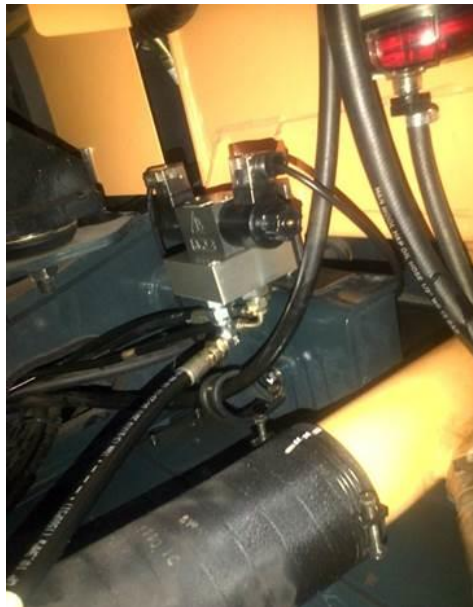
FIGURA 23 - Válvula de Controle Direcional Instalada.
