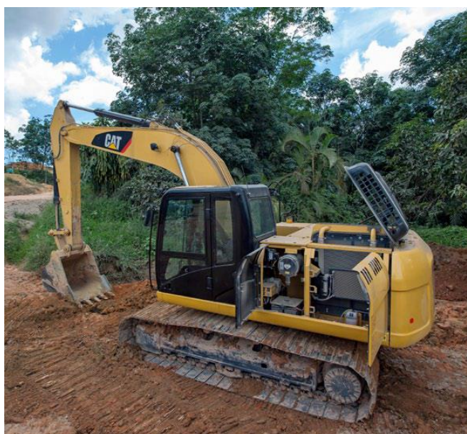
Fonte: Caterpillar (2013). FIGURA 11 - Escavadeira Hidráulica.
